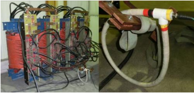
شکل ۶- ترانسفورماتور جریان قوی و کوپل روگوفسکی در ثانویه آن
